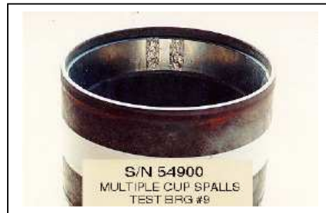
Figure 5: Multiples arrachements dans la bague externe
