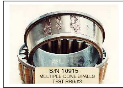
Figure 3: Multiples arrachements dans la bague interne
