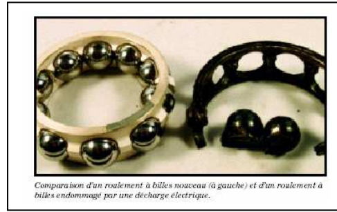
Figure 9 :Une décharge électrique cause une panne moteur en vol
