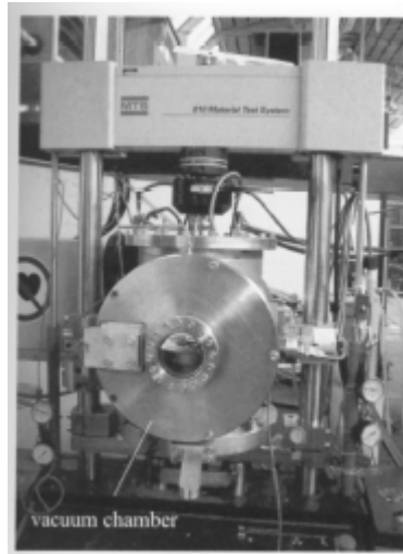
Photo 2-4 Fatigue en traction compression – éprouvette chauffée par induction, Krupp 2007
