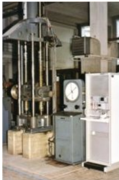
Photo 2-1 Machines hydrauliques pour essais statique et dynamique
