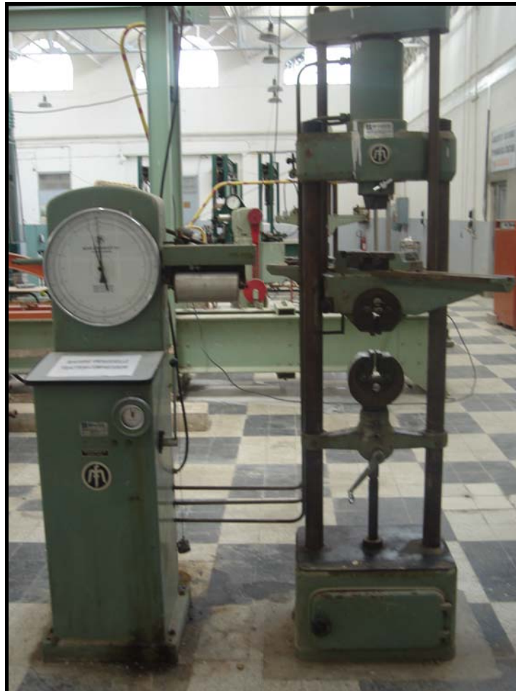
Photo 2-9 : Machine de traction utilisée
