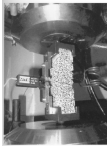
Photo 2-6 Essai de fatigue traction-compression sur un échantillon de mousse d'aluminium, Krupp 2007
