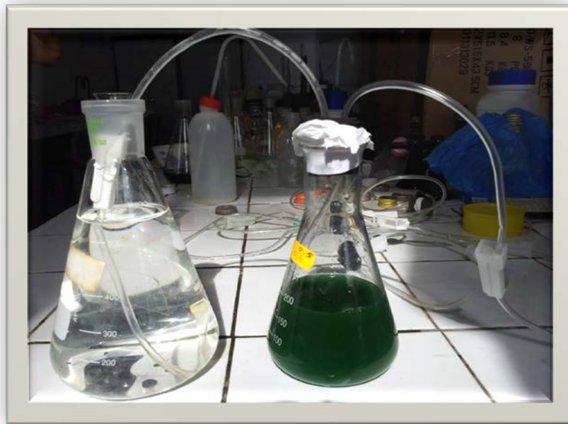
Figure V.7 : Barbotage à l'azote.
