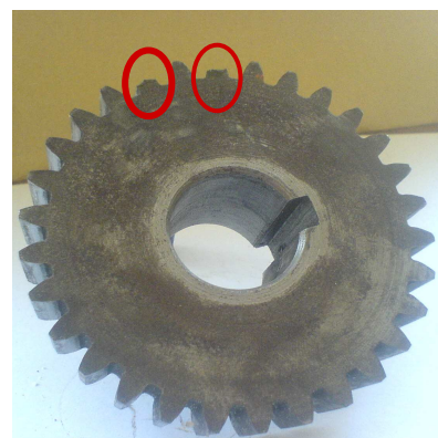
b. Arrachement complet de deux dents ( défaut N°6 )
