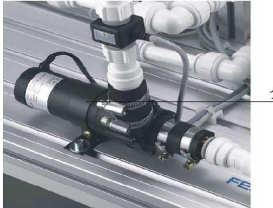
**Figure IV.A.5 : Pompe centrifuge.**
