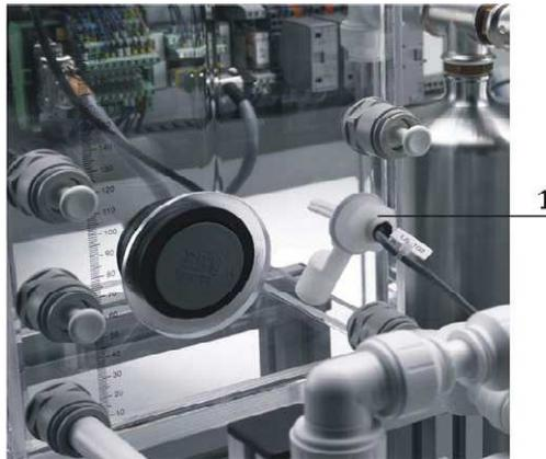
**Figure IV.A.9 : Flotteur pour la détection des seuils de remplissage.**
