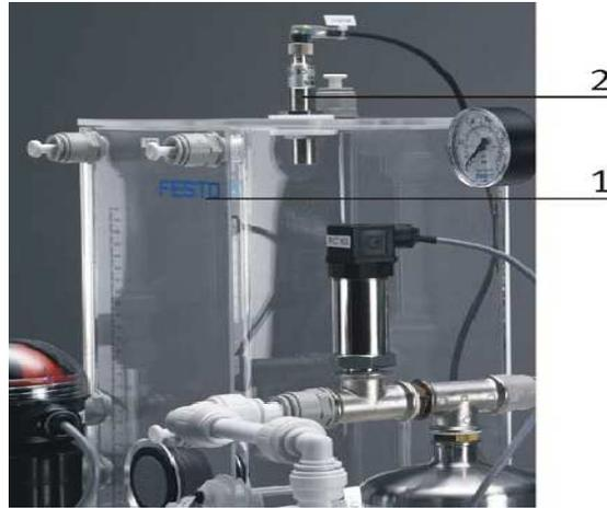
**Figure IV.A.11 : Capteur de niveau ultrasonique.**
