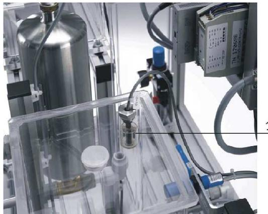
**Figure IV.A.8 : Flotteur de sécurité anti débordement.**
