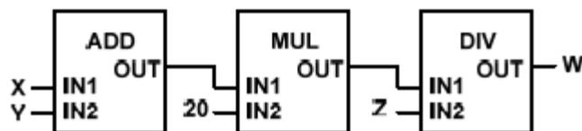
Figure I.A.6 : Exemple d'un programme en Fonction Bloc.
