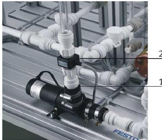
**Figure IV.A.12 : capteur de débit.**
