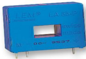
FIGURE 2.6 – Capteur à effet HALL
