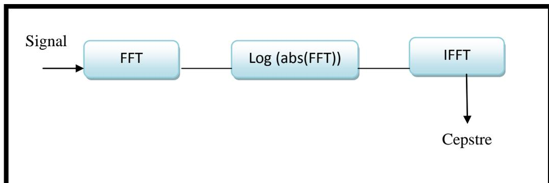
Fig.3.4 : Calcul des coefficients cepstraux par analyse spectrale
