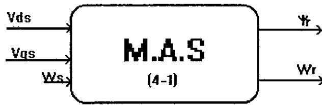
FIG-1- Schéma -bloc de la machine asynchrone alimentée en tension dans un repère synchrone
