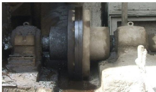
Figure II.6 : ACCOUPLEMENT + les deux paliers vue sur site
