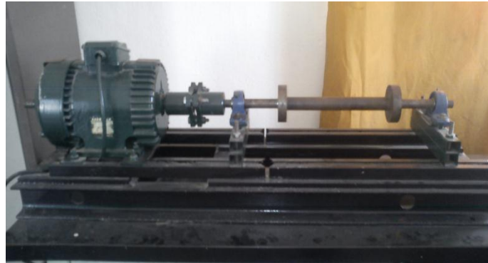
Figure III.3 : Banc d'essai pour étudier le défaut de balourd, dégradations des roulements et le défaut de l'accouplement
