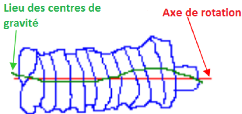
Figure II.9 : Tolérances d'usinage sur un rotor
