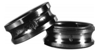
défaut : écaillage de la bague interne
