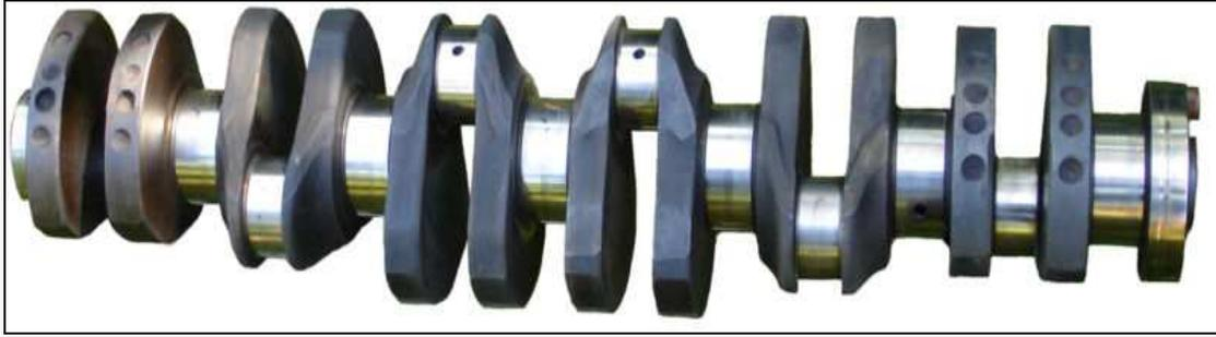
Figure.I.6 . Vilebrequin d'un moteur à 6 cylindres
