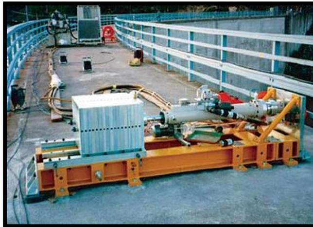
Figure I-14 Excitateur à masse excentrique
