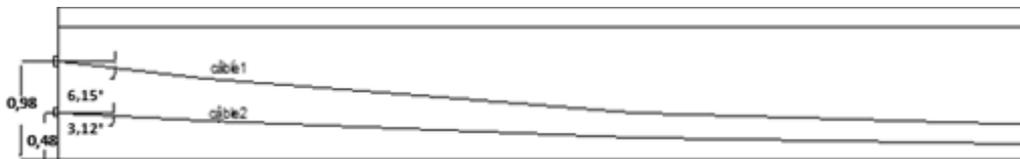
Figure 3-11 Tracé des deux câbles dans la demi-poutre
