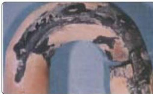
Figure II:8 Rupture par fatigue thermique dans un secteur en U
