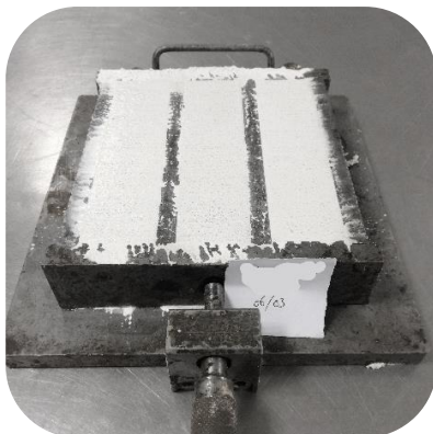
Figure 3.4: Moule remplie de mortier
