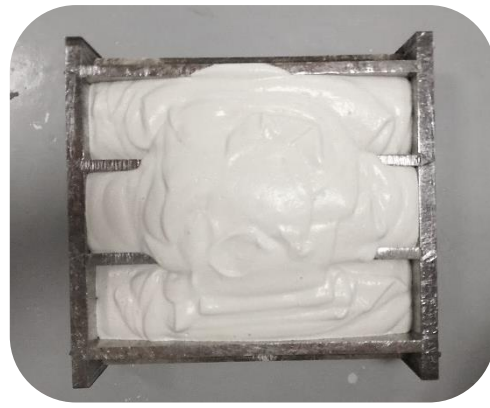
Figure 3.17: Moule rempli avec de la mousse minérale fraîche
