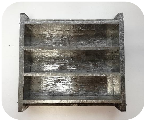
Figure 3.16: Moule enveloppé par le film plastique adhésif
