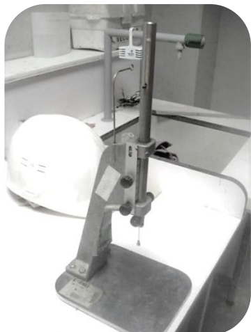
Figure 3.8: Appareil de VICAT
