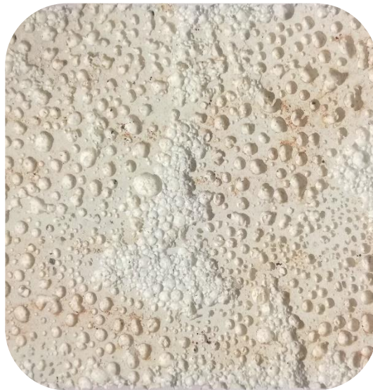
Figure 3.15: Aspect de la surface de la mousse minérale, cas d'utilisation des agents de démoulage, (échelle 1/1)
