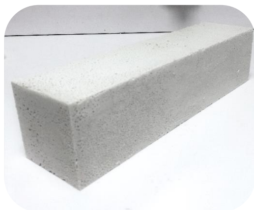
Figure 3.19: Epreuve prismatique 70×70×280 mm
