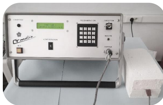
Figure 3.22: Essai au Ct-mètre en cours
