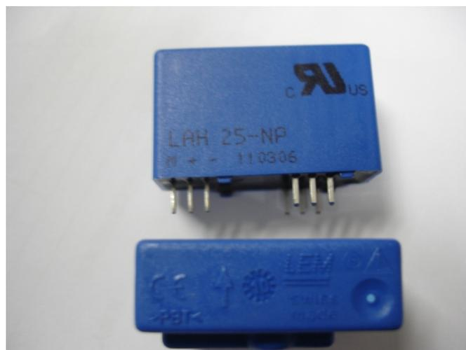
**Figure II.3.** Capteur de courant LAH 25-NP
