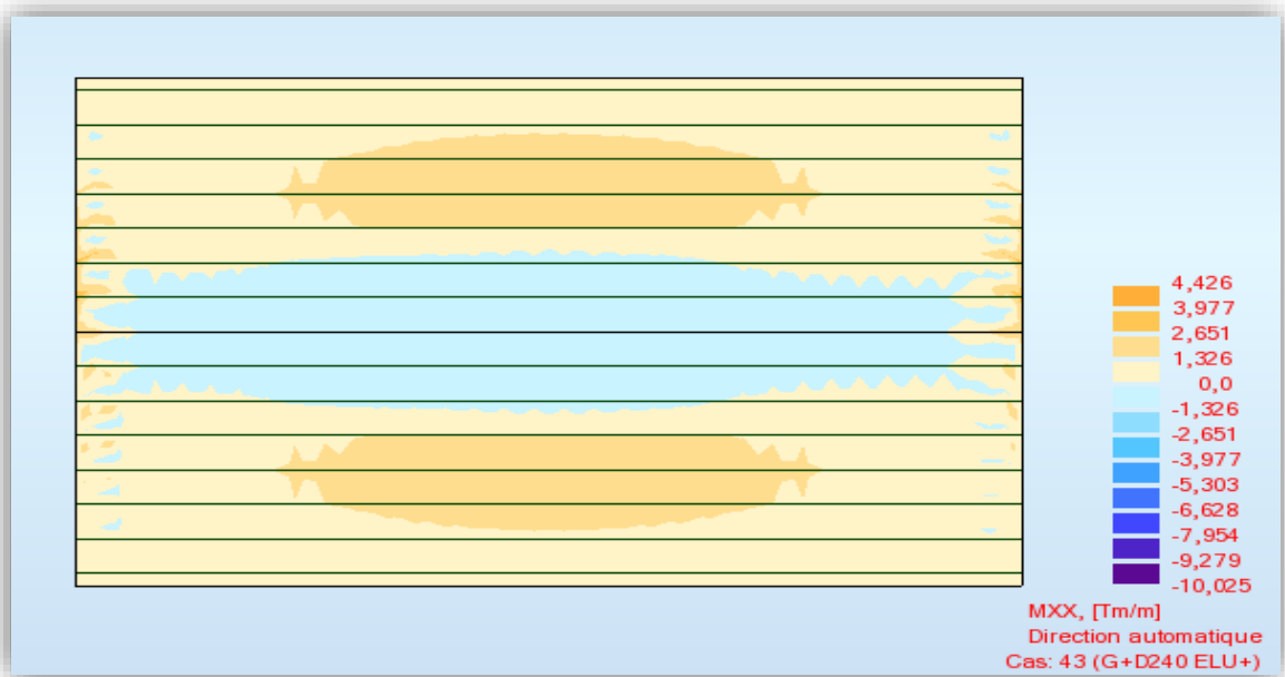
Figure VIII.4 : Cartographie du moment fléchissant dû à la combinaison 3 (selon xx, ELU ( G + D240 ) ).
