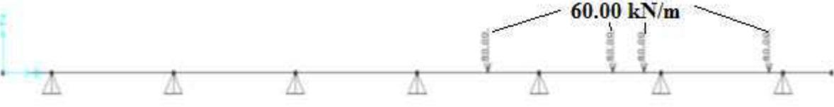
Figure IX.7 : Charge Roulante Bc
