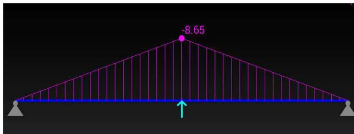
Figure VII.3 : Diagramme de  $\bar{M}$
