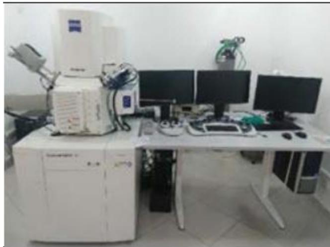
**Figure III.5 :** Image illustrant un microscope électronique à Balayage
