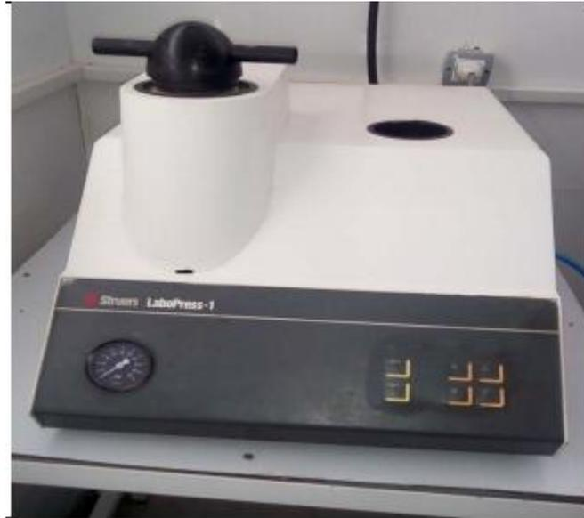
**Figure III.2 :** Image illustrant une Enrobeuse
