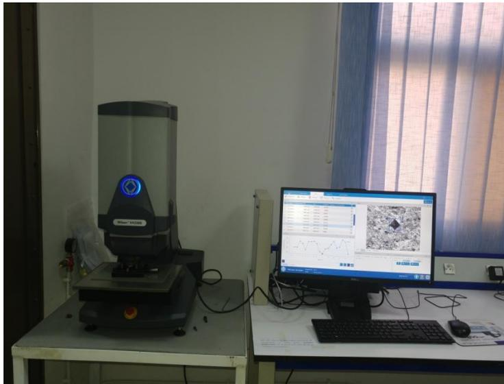
**Figure III.6 :** Image illustrant un microduromètre automatisé
