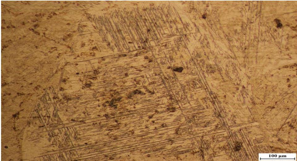
**Figure IV.6 :** Microstructure martensitique du Ti-6Al-4V pour une mise en solution à 1000 °C suivi d'une trempe à l'eau
