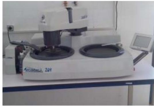
**Figure III.3 :** Image illustrant une polisseuse
