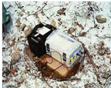
Exemple d'accéléromètre utilisé par l'USGS pour mesurer l'importance du mouvement du sol
