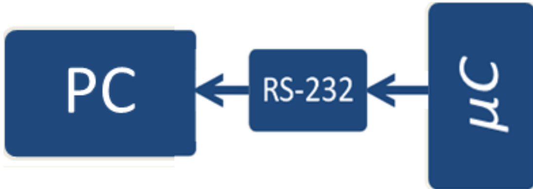
Fig 3.11. La liaison série RS-232, PC ↔ \mu C
