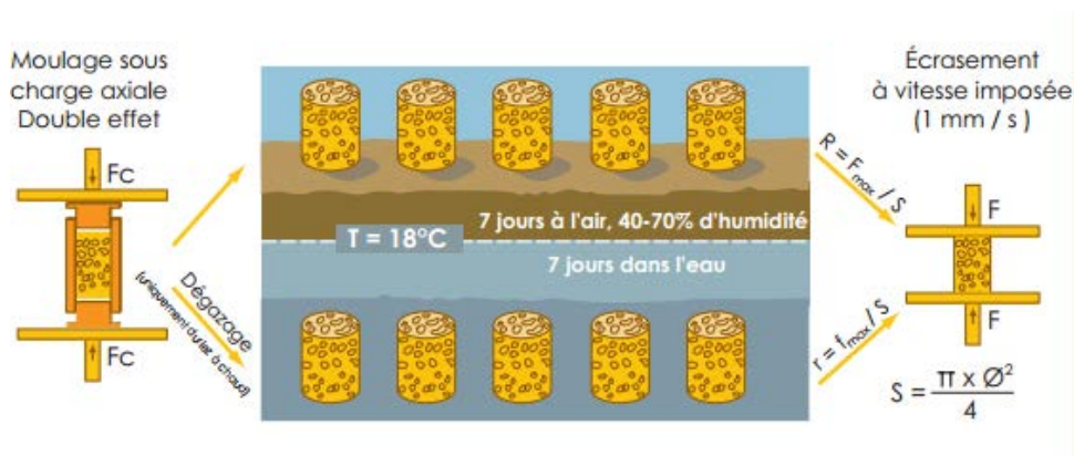
Figure 3.31: Schéma représentant le principe de l'essai Duriez
