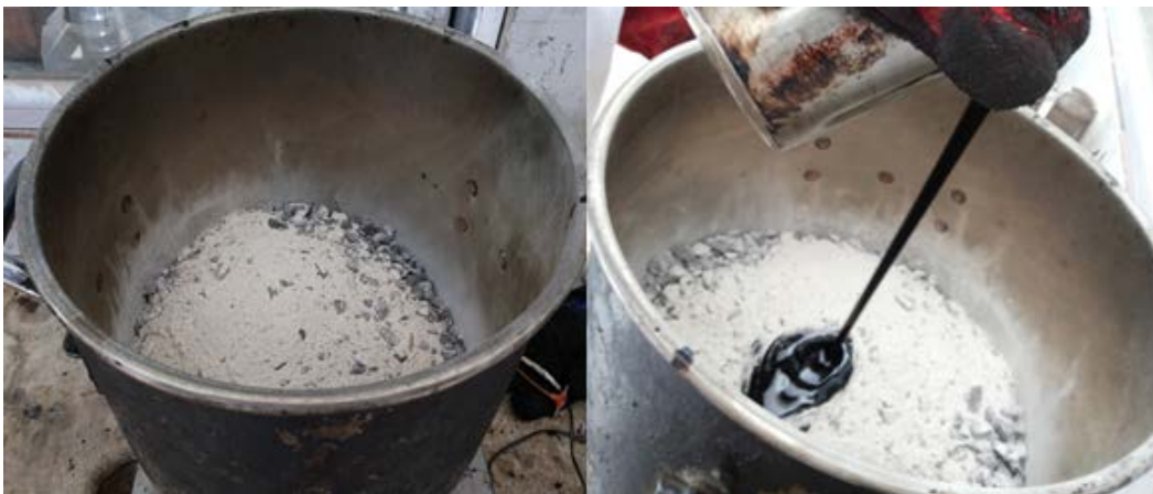
Figure 3.23: Mélange des granulats et du bitume
