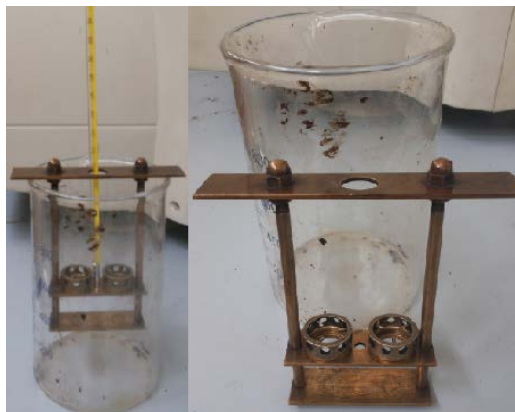
Figure 3.11: Matériel de l'essai du point de ramollissement
