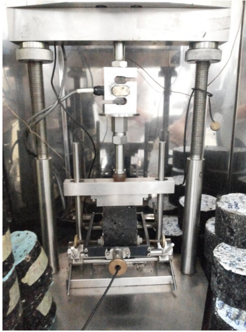
Figure 3.36: Essai de mesure du module dans le NAT
