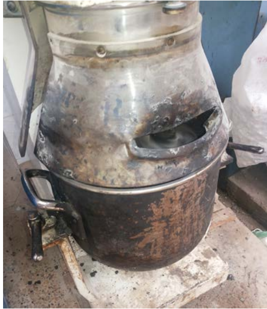
Figure 3.24: Malaxage de l'enrobé
