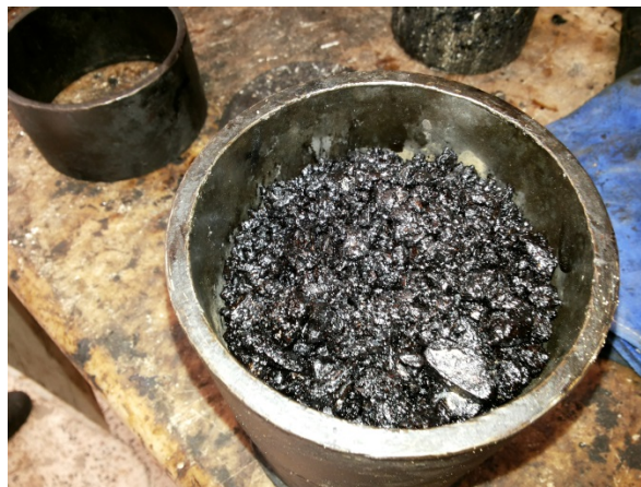
Figure 3.25: Remplissage des moules
