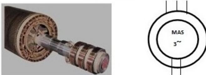
FIGURE 1.3 – Symbole de la machine asynchrone à rotor bobiné
