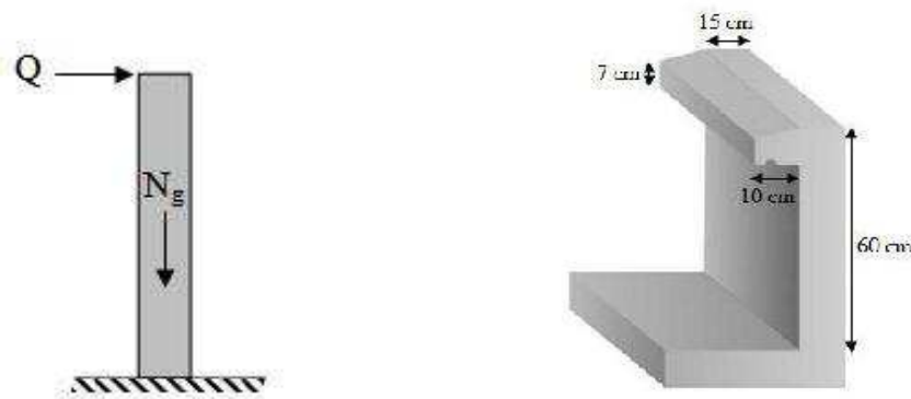
Fig. III.1. Détails et modélisation de l'acrotère
