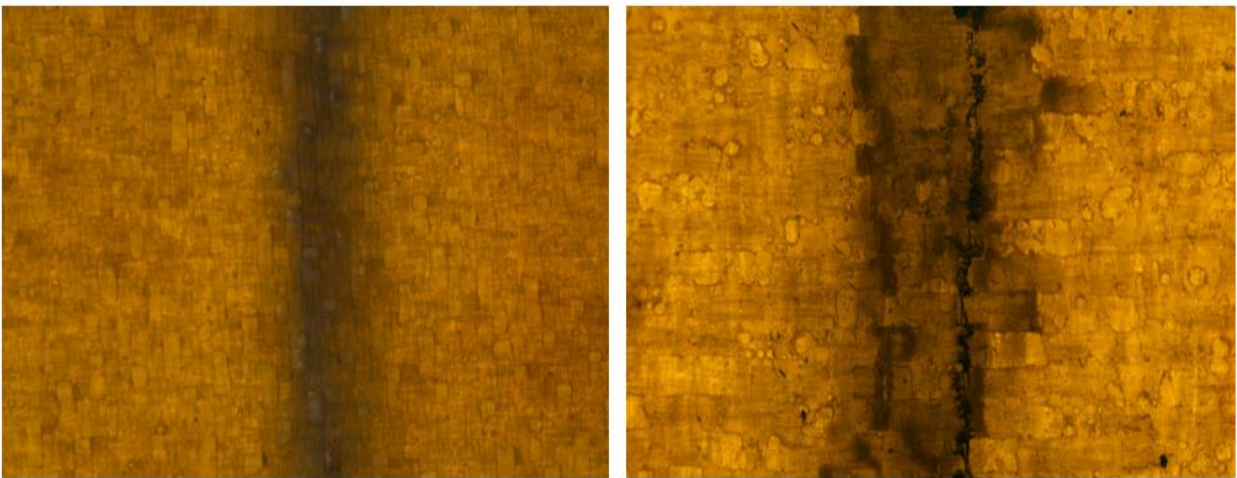
Figure IV-8 : Faciès de rupture dans un composite stratifié de verre (0°/90°)
