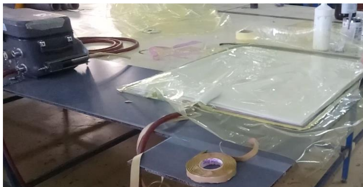
Figure I-13 : Couverture du moule
