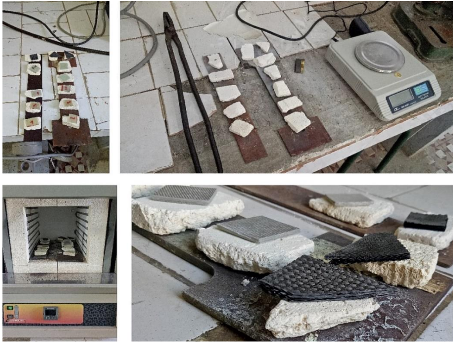
Figure II-2 : Calcination des stratifiés pour la mesure des fractions massique et volumiques
