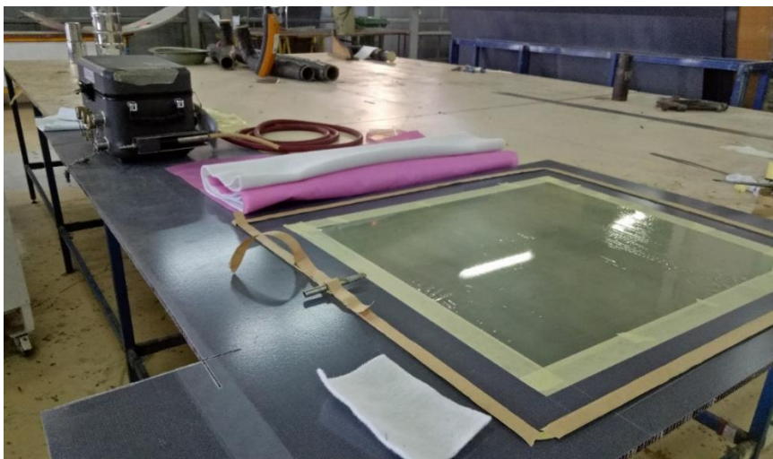
Figure I-9 : Préparation du moule
