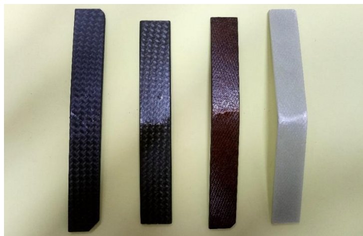
Figure III-10 : Eprouvettes de flexion endommagées
