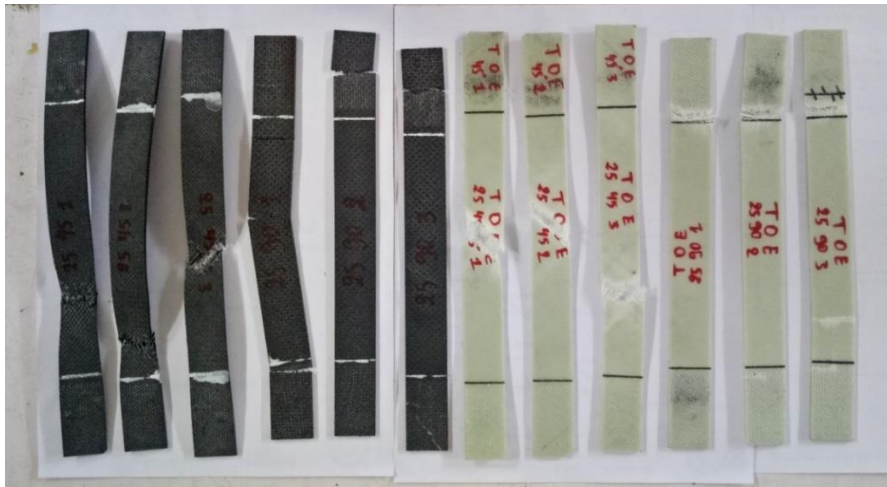
Figure III-2 : Epreuves des composites stratifiés endommagées par traction
