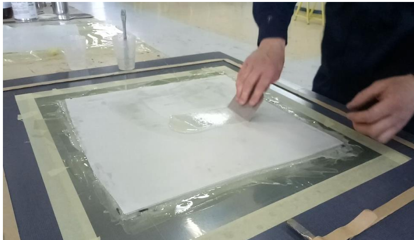
Figure I-11 : Moulage de la résine
