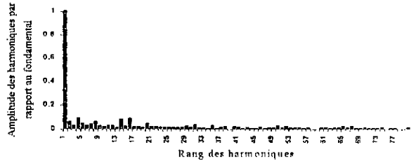
Fig III.23-Tension simple V_a de l'onduleur triphasé à trois niveaux et son spectre d'harmonique ( m=9 )
