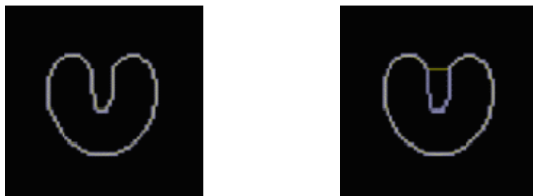
Figure V-1 : La convergence à une concavité, à gauche la méthode GVF, à droite celle du snake [3].
