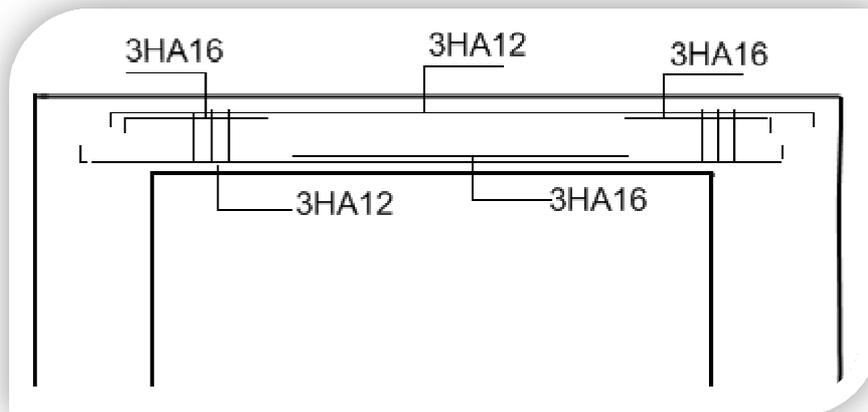
Fig.5-7 : Coupe longitudinale de la poutre secondaire (25×40)
