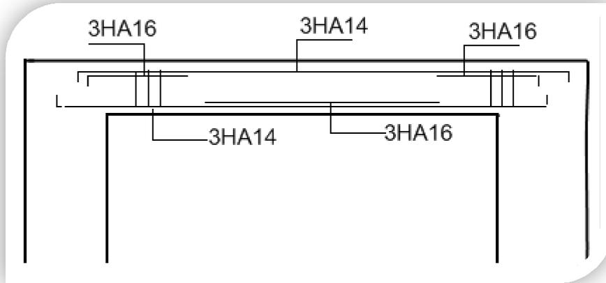
Fig.5-6 : Coupe longitudinale de la poutre principale (30×45)
