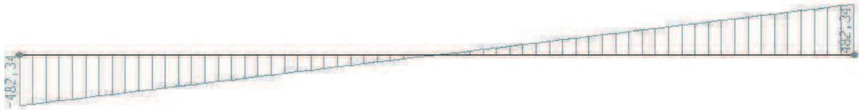
Figure V. 15: Diagramme de T dû au poids propre des poutres
