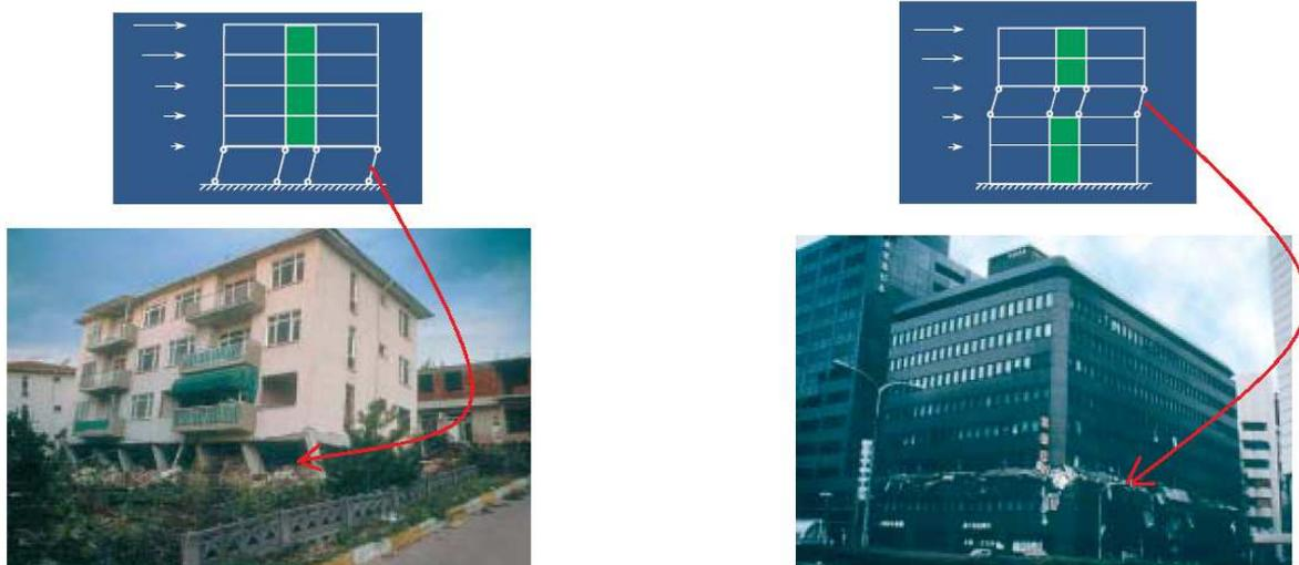
**Figure IV.6** Niveaux flexibles
