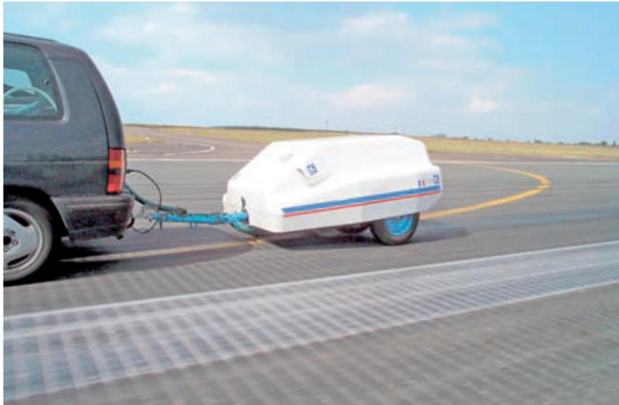
Figure III.3 : Mesure automatique de la glissance (la remorque IRV)
