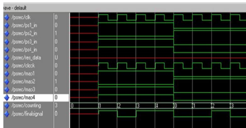
Fig. 4-26: Simulation du convertisseur parallèle série du récepteur
