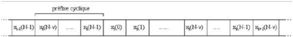
Fig. 1.7: Principe du préfixe cyclique
