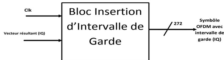
Fig. 3-10: L'entité de l'Insertion de l'Intervalle de Garde
