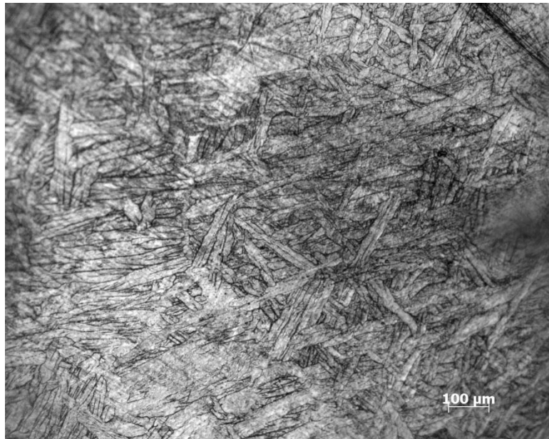
Figure 14: microstructure de Zy-4 traité à 1020 °C
