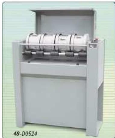
Le coefficient Micro Deval (MDE) est le pourcentage d'éléments passant au tamis de 2 mm par rapport au poids total de l'échantillon.
