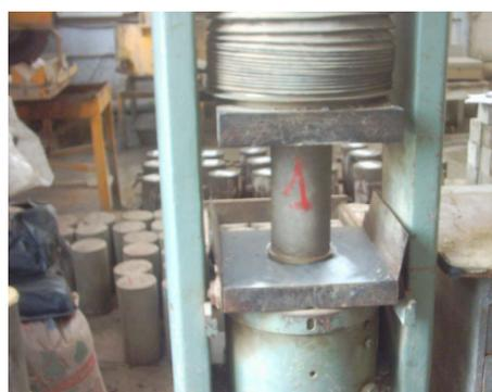
FIG VI.3 : Essai de compression
