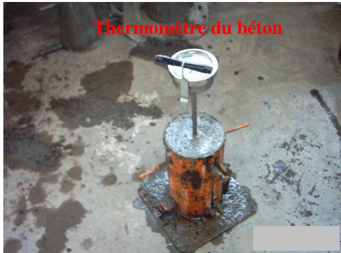
**Essai de cone d'abrahme**
