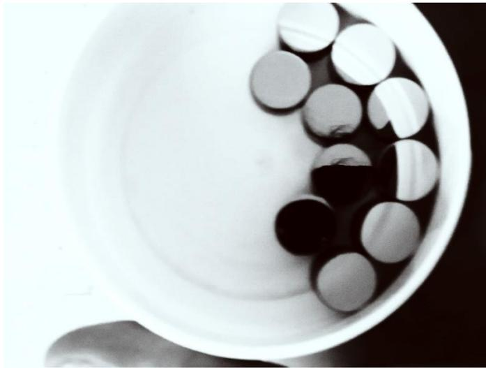
**Figure 2.1 : substrats d'Acier 316L après polissage**
