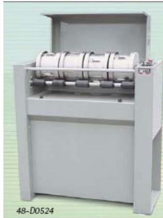
La mesure de ce coefficient (MDE) permet d'évaluer la résistance à l'usure du matériau.
