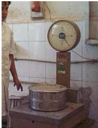
**Figure VII.4 :** essai de stabilité au tamis
