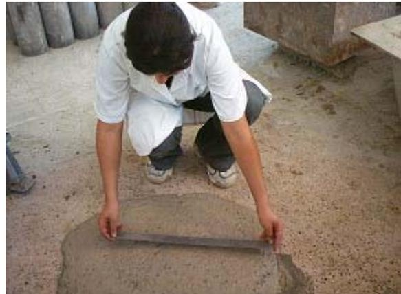
Figure VII.2 : essai d'étalement
