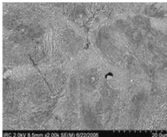
**Figure I.3:** *Acier perlitique de construction laminée*[7]
