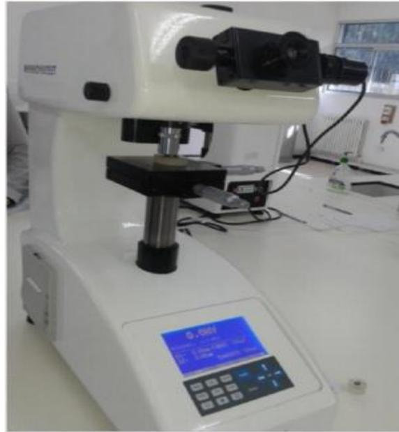
**Figure II.10 :** *Microduromètre utilisé pour les essais*
