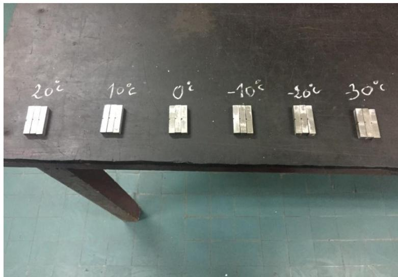
**Figure II.15** : Configuration des éprouvettes de résiliences
