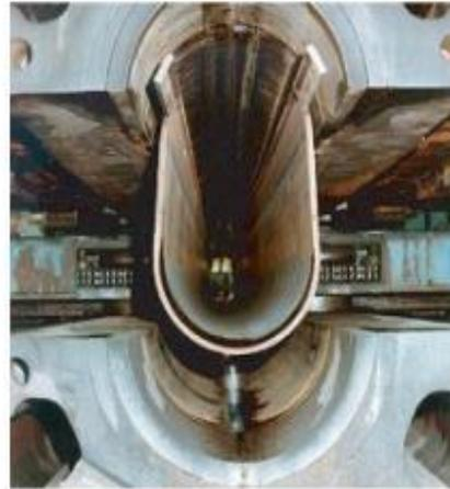
**Figure I.13 :** *Formage sous forme 'U'* [37]
