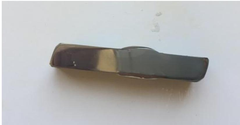
**Figure II.7 :** *L'échantillon après l'opération de polissage*
