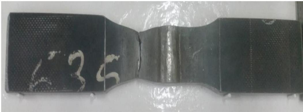
**Figure III.7 :** Traction de cordon de soudure
