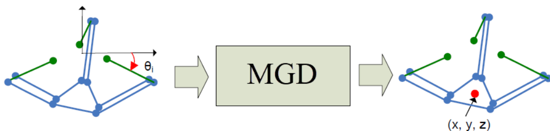
Figure 1.4 Modèle géométrique direct du Delta [7]
