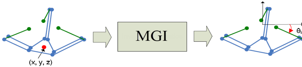
Figure 1.10 Modèle géométrique indirect du Delta [7]
