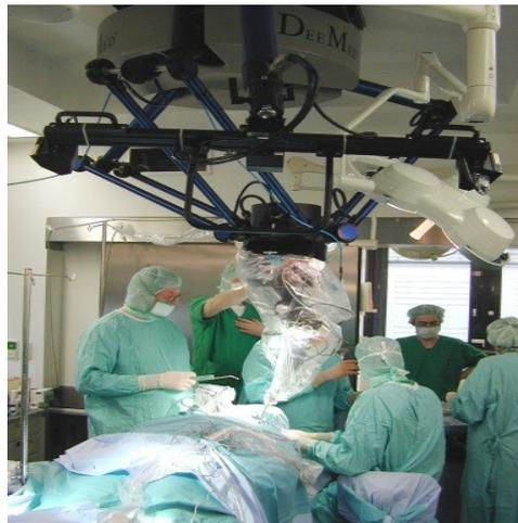
Fig.2.1.a Robot Delta en chirurgie
