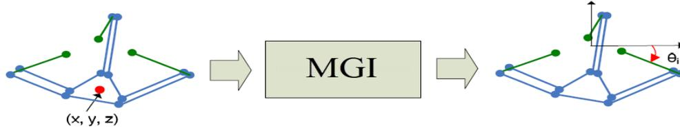
Fig.3.7 Modèle géométrique indirect du Delta [7]
