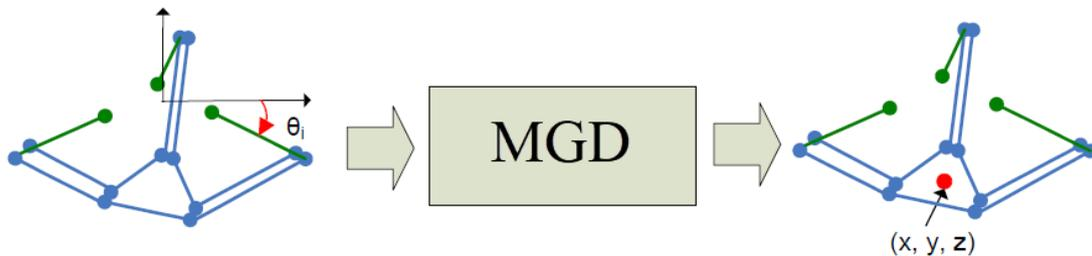
Fig.3.4 Modèle géométrique direct du Delta [7]
