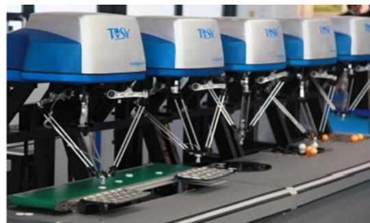
Fig.2.1.b Robot Delta en industrie alimentaire et pharmaceutique
