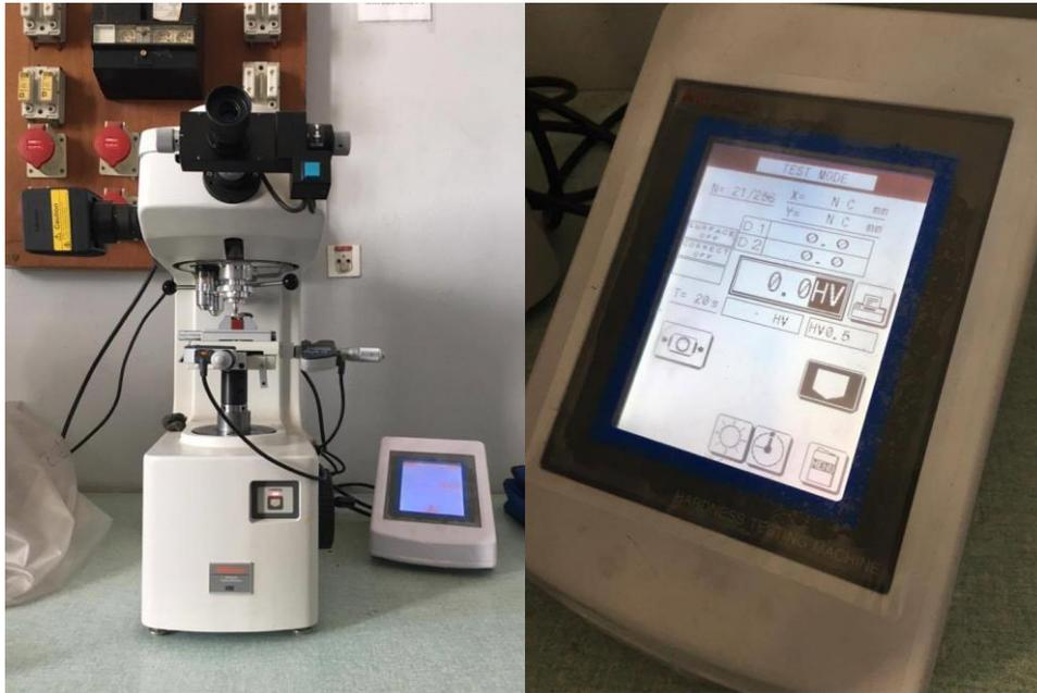
**Figure IV.26** Micro-duromètre utilisé, de marque Mitutoyo
