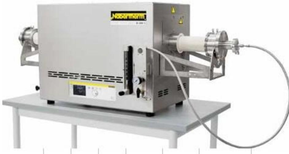
**Figure IV.15** Le four sous vide utilisé pour effectuer les deux traitements thermiques
