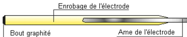
Figure II.5 Schéma d'une électrode enrobée [11]
