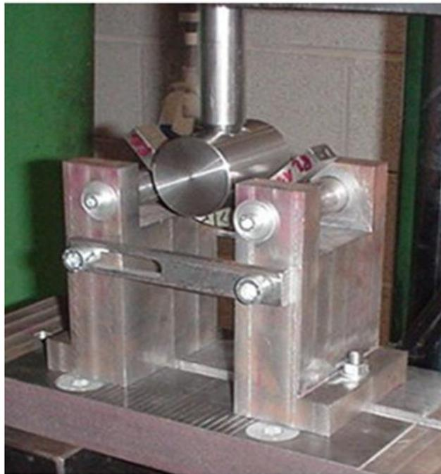
**Figure IV.21** L'essai de pliage en execution
