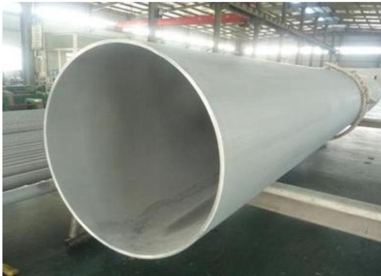
**Figure IV.2** Pipe API x60 fabriqué en acier A312 TP316L
