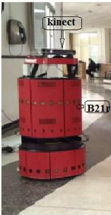
Fig. 2.1 : Robot mobile B21r
