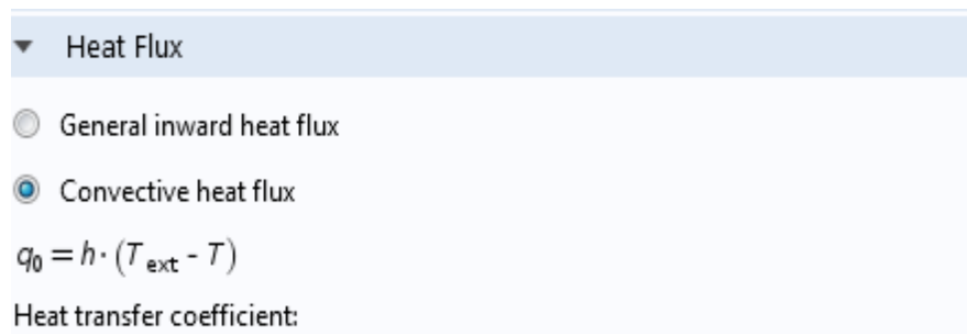
Figure IV.15: capture d'écran des équations utilisées pour le calcul du transfert thermique de convection
