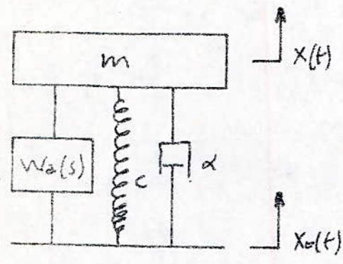
c'est un système constitué d'un ou plusieurs systèmes asservis. On remarque que le système passif existe.
