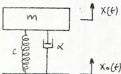
c'est un système passif représenté par un ressort de rigidité  $c$  et un amortisseur de constante  $\alpha$ .  $m$  représente la masse du
