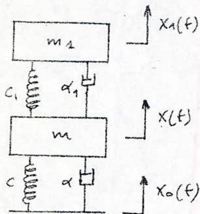
Le système de vibro-isolation est constitué par: un ressort de rigidité  $c$  et un amortisseur de constante  $\alpha$ ,  $m_1$  étant la masse à vibro-isoler
