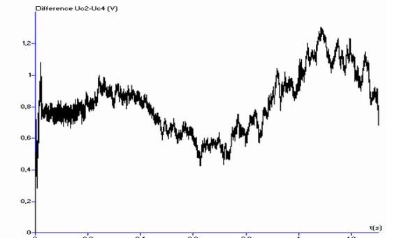
Figure IV.63 Tensions  $U_{c2}$  et  $U_{c4}$  et leur différence  $U_{c2}-U_{c4}$
