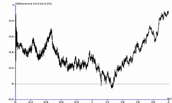
Figure III.4 Tensions  $U_{c1}$  et  $U_{c3}$  d'entrée de l'onduleur et la différence  $U_{c1}-U_{c3}$
