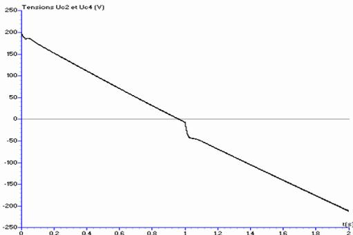
Figure III.66 Tensions  $U_{c2}$  et  $U_{c4}$  d'entrée de l'onduleur et la différence  $U_{c2}-U_{c4}$
