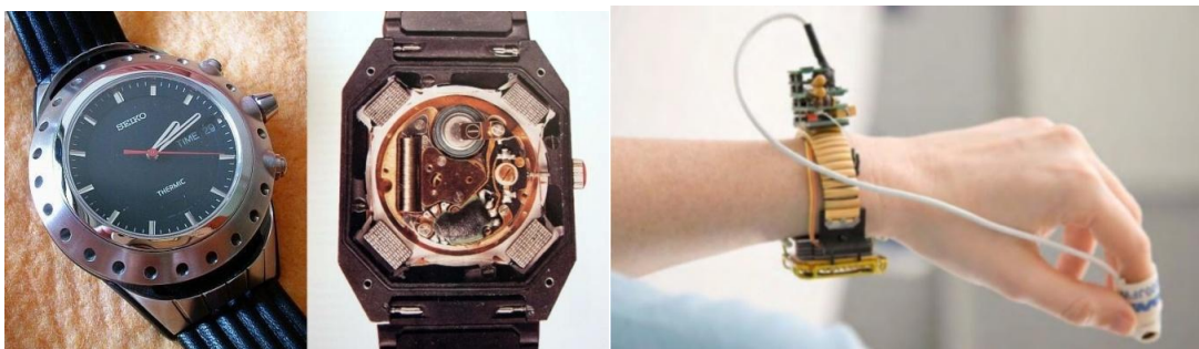
Figure 1.10. Montre et appareil médical (oxymètre à pouls) alimentés par des dispositifs thermoélectriques.
