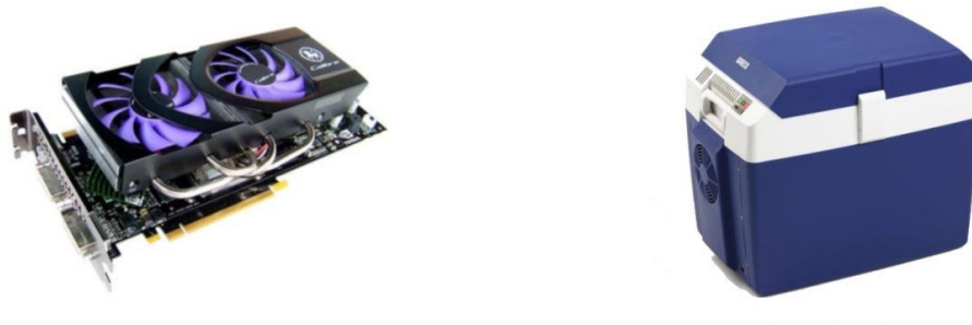
Figure 1.7. Microprocesseur et glacière de camping équipés de modules à effet Peltier.
