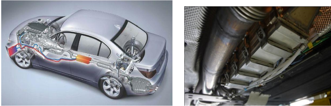
Figure 1.9. Représentations de générateurs thermoélectriques équipant des prototypes de véhicule.
