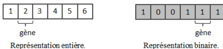
FIGURE II.1 – Principe de codage.
