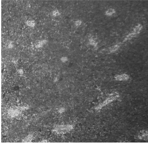
Figure 4.15 : Microstructure de l'alliage après revenu à 400 °C pendant 25 min, G=500X
