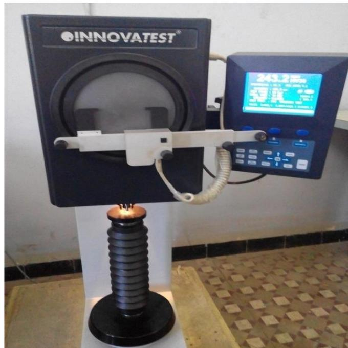
Figure 3.4 : *durometre utilise*
