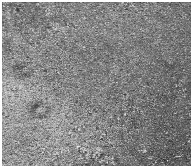
Figure 4.20: Microstructure de l'alliage revenu à 400 °C pendant 50 minutes. G=200
