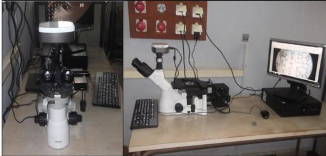
Figure 3.3 : Microscope optique utilisé.
