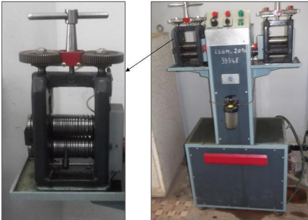
Figure 3.1 laminoir a double cylindre semi-automatique
