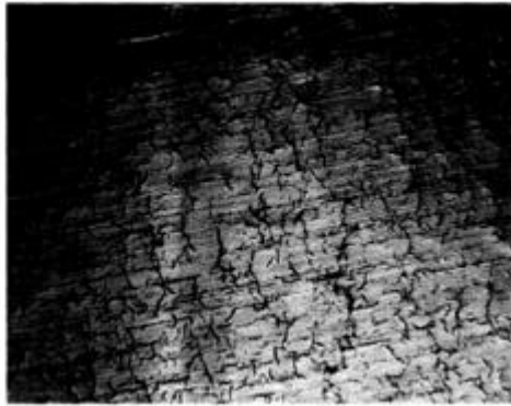
Figure 1.7: faïençage de fatigue thermique dans un acier inoxydable austénitique [7].
