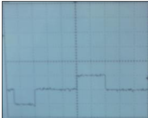
Figure II.30 : Tension de sortie pour un blocage de U2
