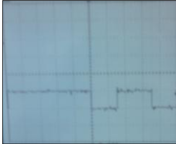
Figure II.34 : Tension de sortie pour un blocage de U2
