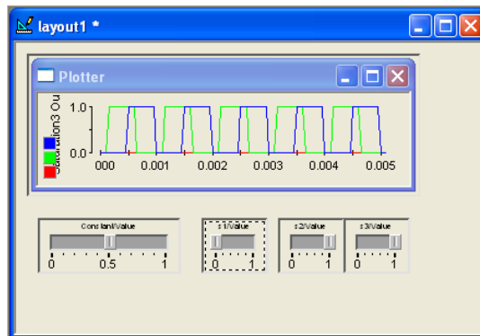
Figure II.27 : signaux de commande pour un blocage U1
