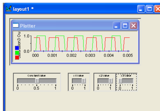
Figure II.31 : signaux de commande pour un blocage U3
