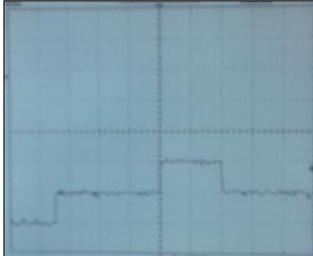
Figure II.32 : Tension de sortie pour un blocage de U3
