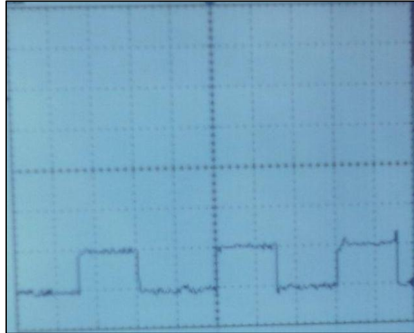
Figure II.13 : Tension de sortie pour alpha 0.2
