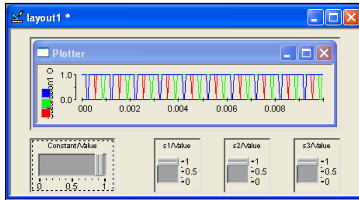
Figure II.16: Signaux de commande pour un rapport cyclique 0.8
