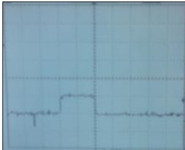
Figure II.35 : Tension de sortie pour un blocage de U3
