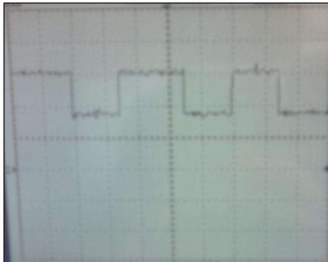
Figure II.19 : Tension de sortie pour alpha 0.5
