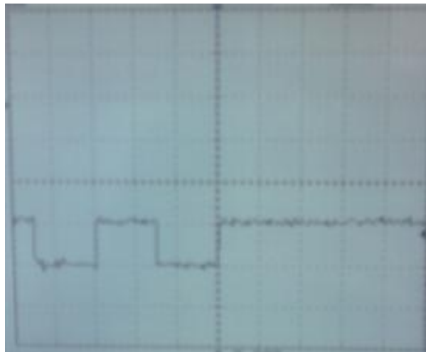
Figure II.33 : Tension de sortie pour un blocage de U1
