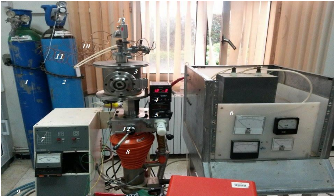
Figure III-6 Dispositif expérimental de dépôt de couche mince par PVD diode DC.
