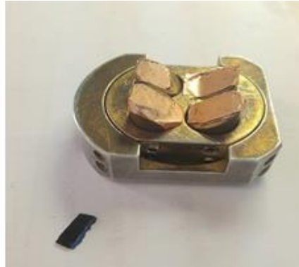
Figure IV-3 Porte substrat du MEB incliné à 45°.
