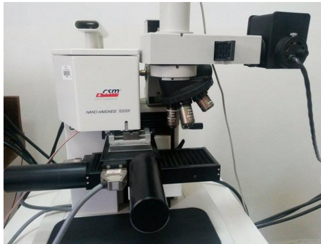
Figure III-20 Dispositif de nano indentation.
