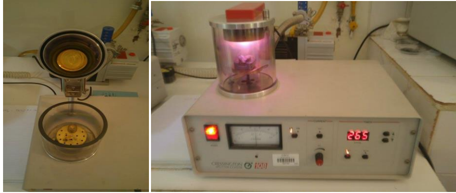
Figure III-17 Dispositif de métallisation à l'or.
