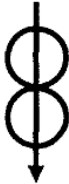
Configuration longitudinale (tandem) Spots l'un derrière l'autre selon l'axe défini par le plan de joint
