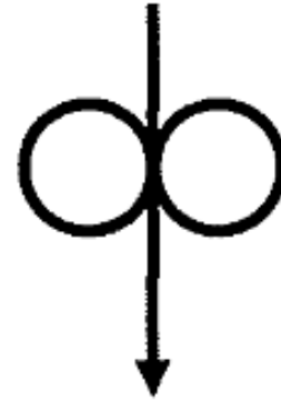
configuration transversale Spots côte à côte selon l'axe défini par le plan de joint
